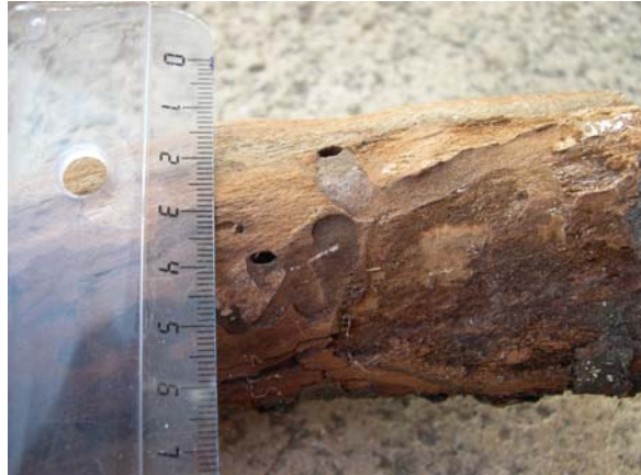
Trous/Ausbohrlöcher Fori d'uscita
