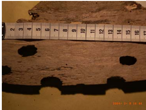
Trous de sortie Ausbohrlöcher Fori d'uscita
